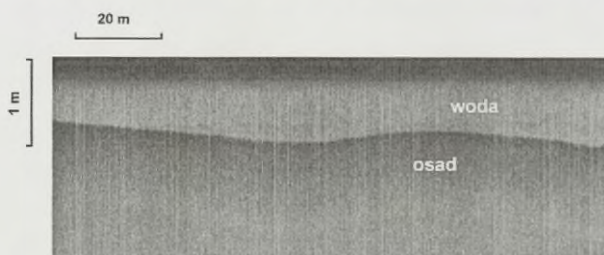
Ryc. 1. Obraz odczytu echosondy – wyraźna linia graniczna pomiędzy wodą i osadem dennym
