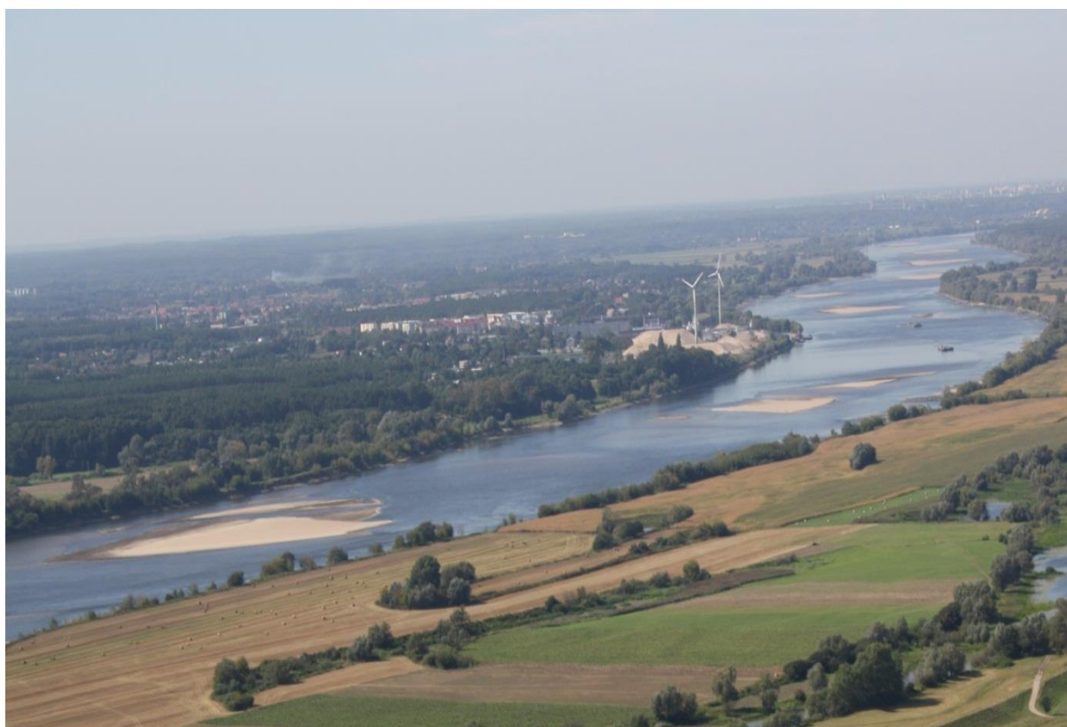
Fot. 1. Naprzemienny układ łąch skośnych, charakterystyczny dla uregulowanego koryta Wisły – 759-768 km (fot. 09.09.2012 r.).
