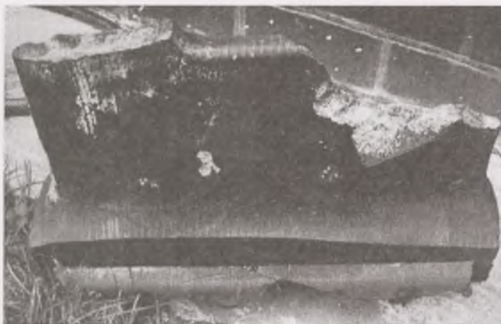
Ryc. 11. Ster grafitowy z rakiety V-2 z okolic Wierzchucina, wg: http://www.odkrywca.pl/pokaz-watek.php?id=124579
