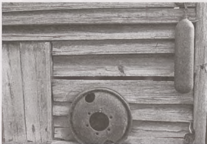
Ryc. 14. Butla do sprężonego powietrza z rakiety V-2 z Lisin
