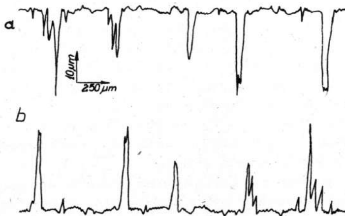
Rys. 1. Przykłady różnych pod względem użytkowym profili nierówności powierzchni o takim samym R_z i R_{max} nierówności
