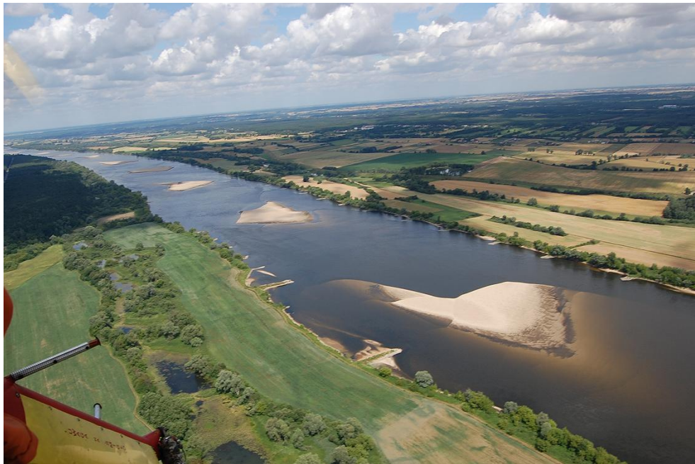
Fot. 4. Uregulowany w XIX wieku odcinek Wisły powyżej Torunia z naprzemianległym układem piaszczysto-żwirowych łach skośnych.
