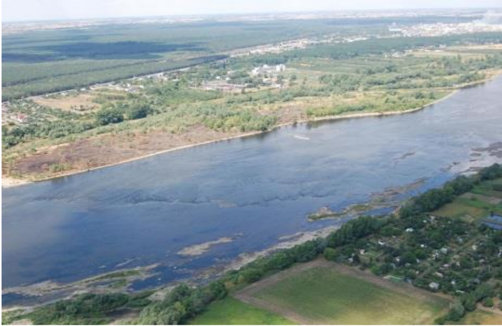
Fot. 3. Po erozyjne progi kamienno-ilaste dna koryta Wisły poniżej zapory we Włocławku, uniemożliwiające transport wodny już przy średnich stanach wody.
