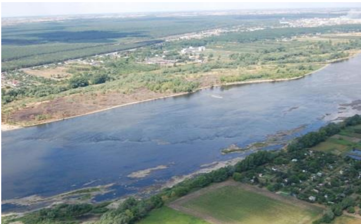
Fot. 6. Próg kamienno-gliniasto-ilasty na odcinku Wisły poniżej Zbiornika Włocławskiego, powstały w wyniku erozji wgłębnej i „usunięcia” aluwii rzecznych, całkowicie eliminujący transport wodny, sprzyjający tworzeniu się zatorów śryżowo-lodowych (fot. M. Habel, 2007).
