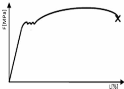
Rysunek. 4.1 Materiał z wyraźną granicą plastyczności.
